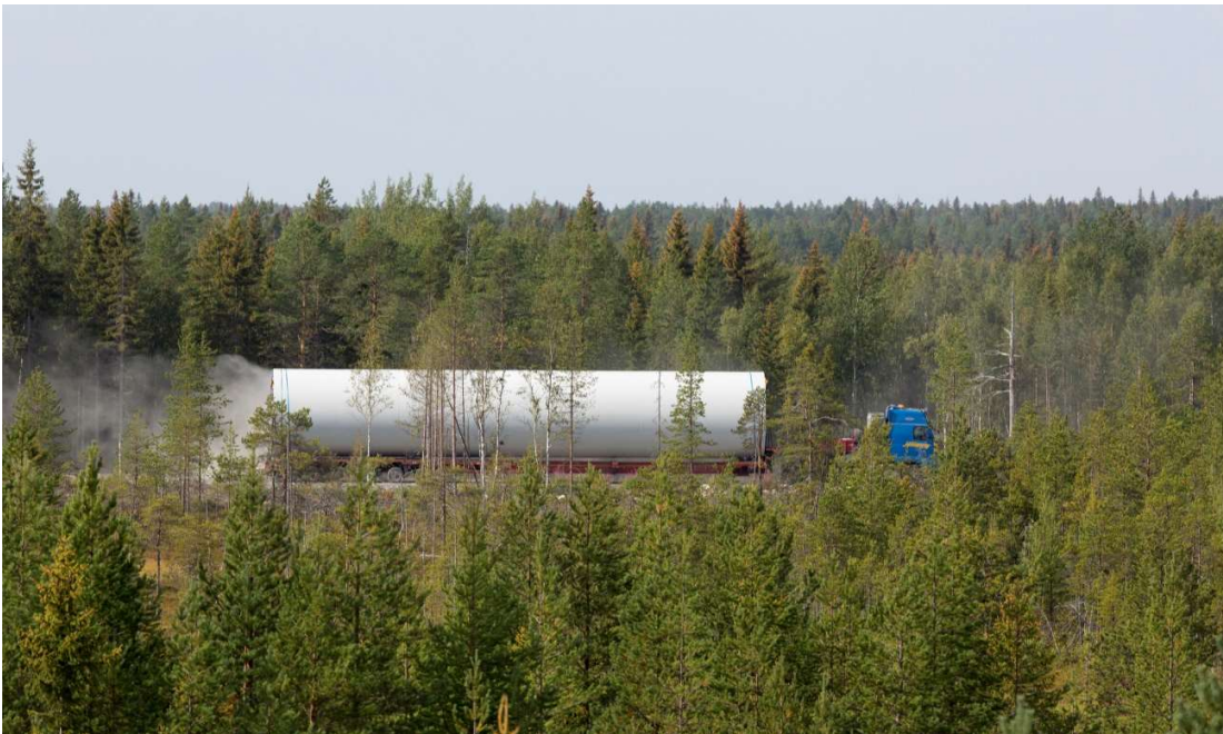
Kuva 4.22 Tuulivoimalan torniosien kuljetusta (FCG Finnish Consulting Group Oy).
